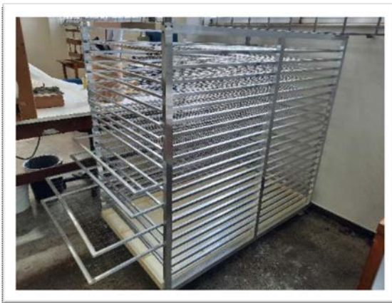
Imagem 111: Secadora de documentos horizontal.
