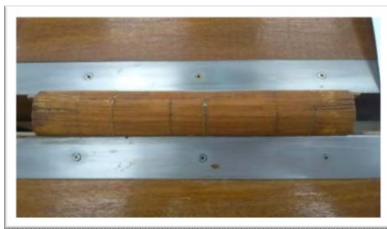
Imagem 15: Livro em prensa vertical para remoção de cola da lombada.
