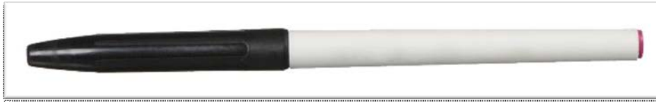
Imagem 87: Caneta para medir acidez e alcalinidade do papel.
