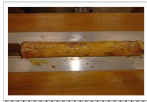
Imagem 14: Livro em prensa vertical para remoção de cola da lombada.
