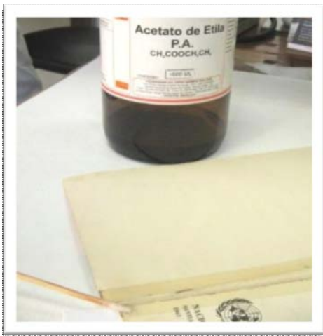
Imagem 31: Aplicação de fita adesiva com acetato de etila.
