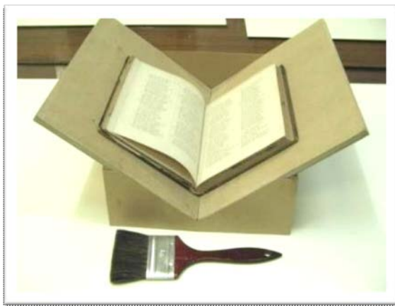
Imagem 24: Suporte de nivelamento de madeira.
