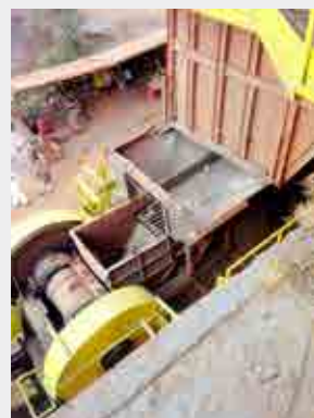
Partes móveis (roletes de correia transportadora) sem proteção Fonte: Arquivo do autor
