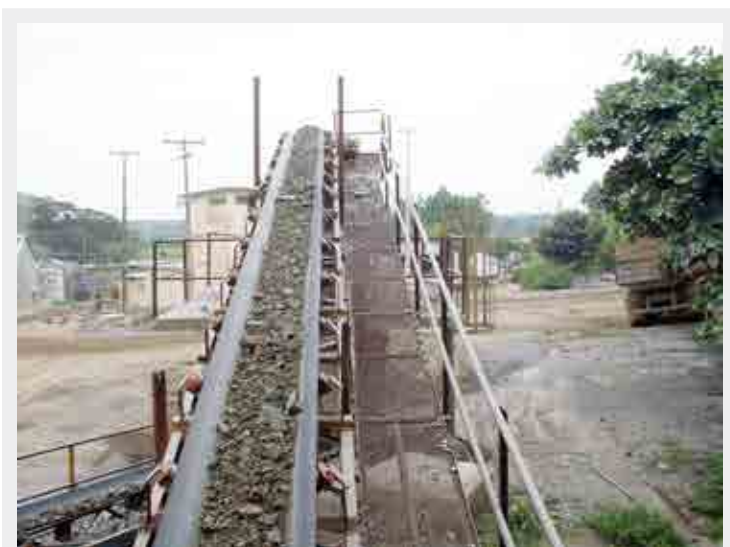
Partes móveis (roletes de correia transportadora) sem proteção Fonte: Arquivo do autor
